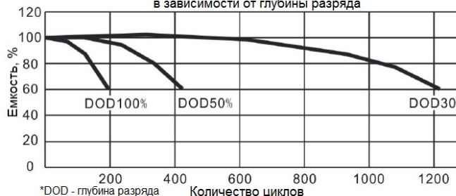
Количество жизненных циклов батареи в зависимости от глубины разряда
