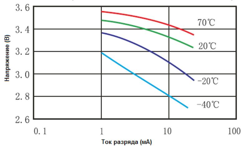
**Зависимость емкости элемента питания от температуры и тока разряда:**
