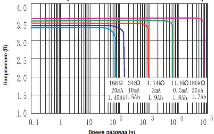
**Зависимость напряжения на элементе питания от тока разряда:**
